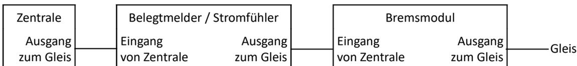
Abbildung 6: Zentrale → Belegtmelder → Bremsmodul → Gleis (Prinzip 2)
