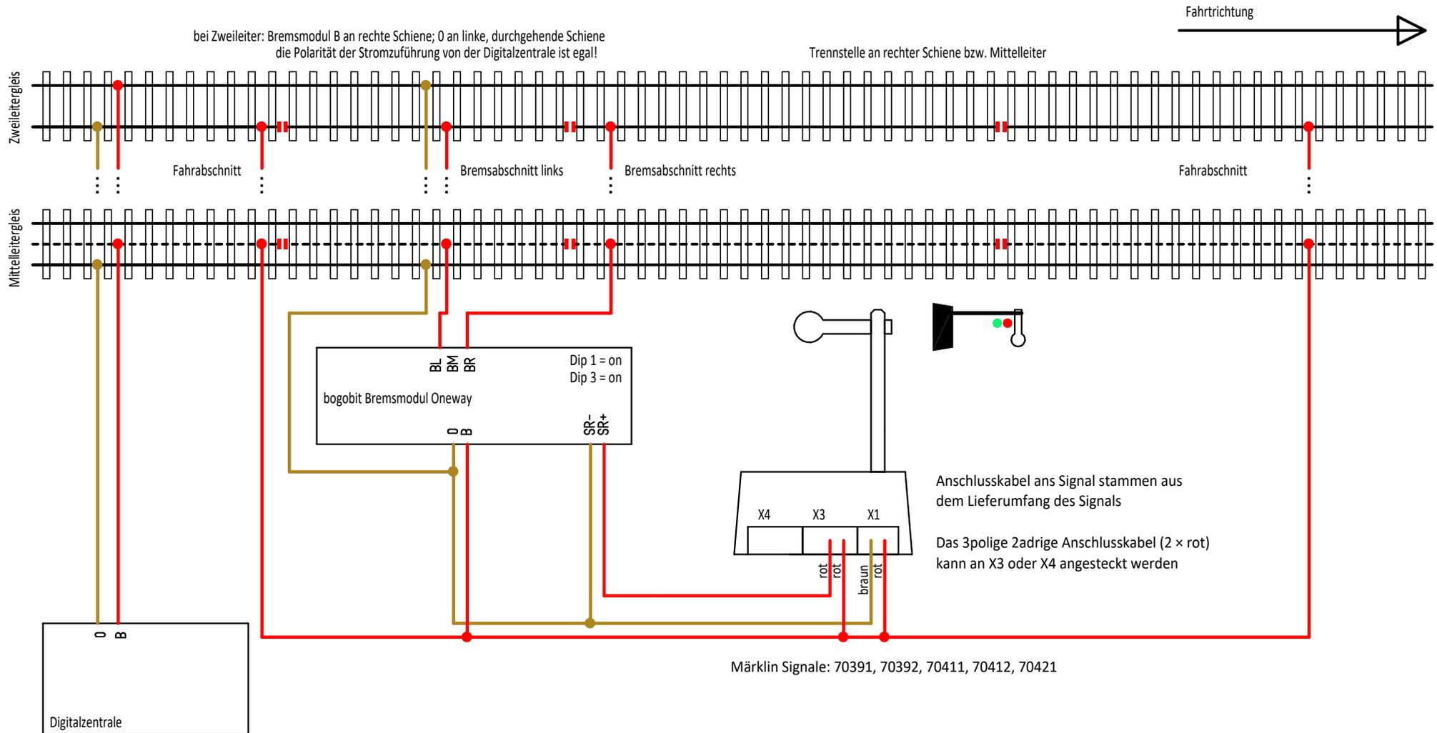
Dieses Prinzip der Ansteuerung ist in beiden Fahrrichtungen anwendbar. Dann Dip 3 = off.
