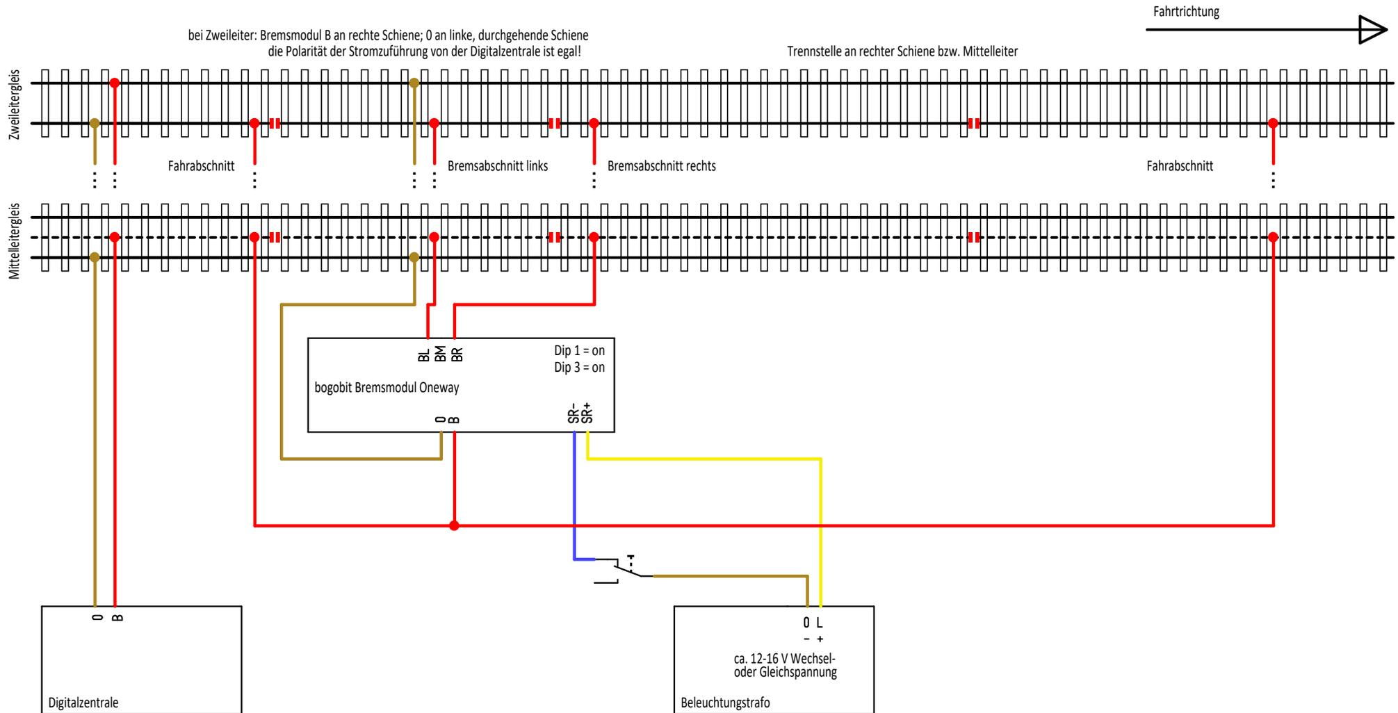
Der Schaltkontakt kann mit einem Schalter oder Schaltdecoder realisiert werden
