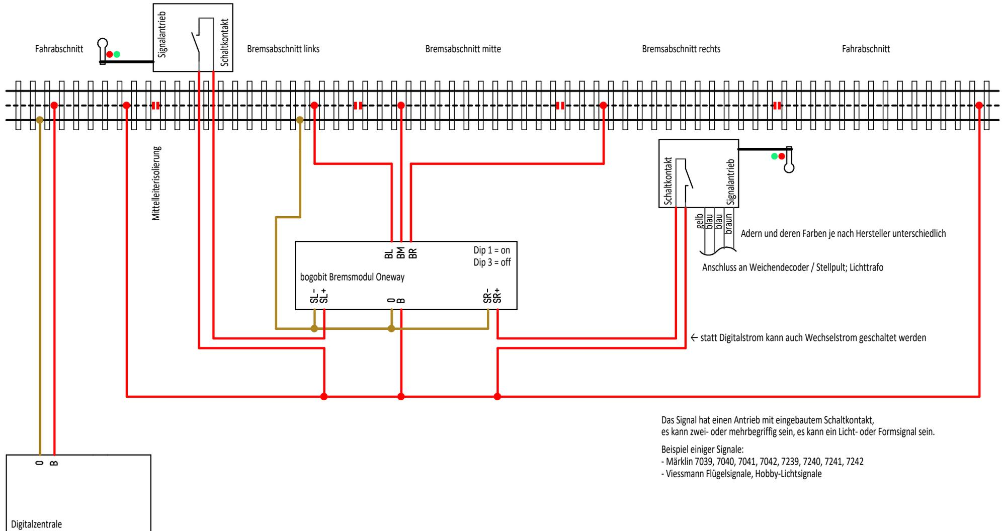
Das Signal hat einen Antrieb mit eingebautem Schaltkontakt, es kann zwei- oder mehrbegriffig sein, es kann ein Licht- oder Formsignal sein.
