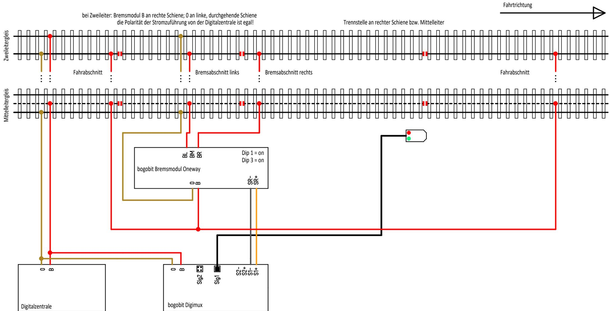
Der Schaltausgang des Digimux wird mit dem Steuereingang des Bremsmoduls verbunden
