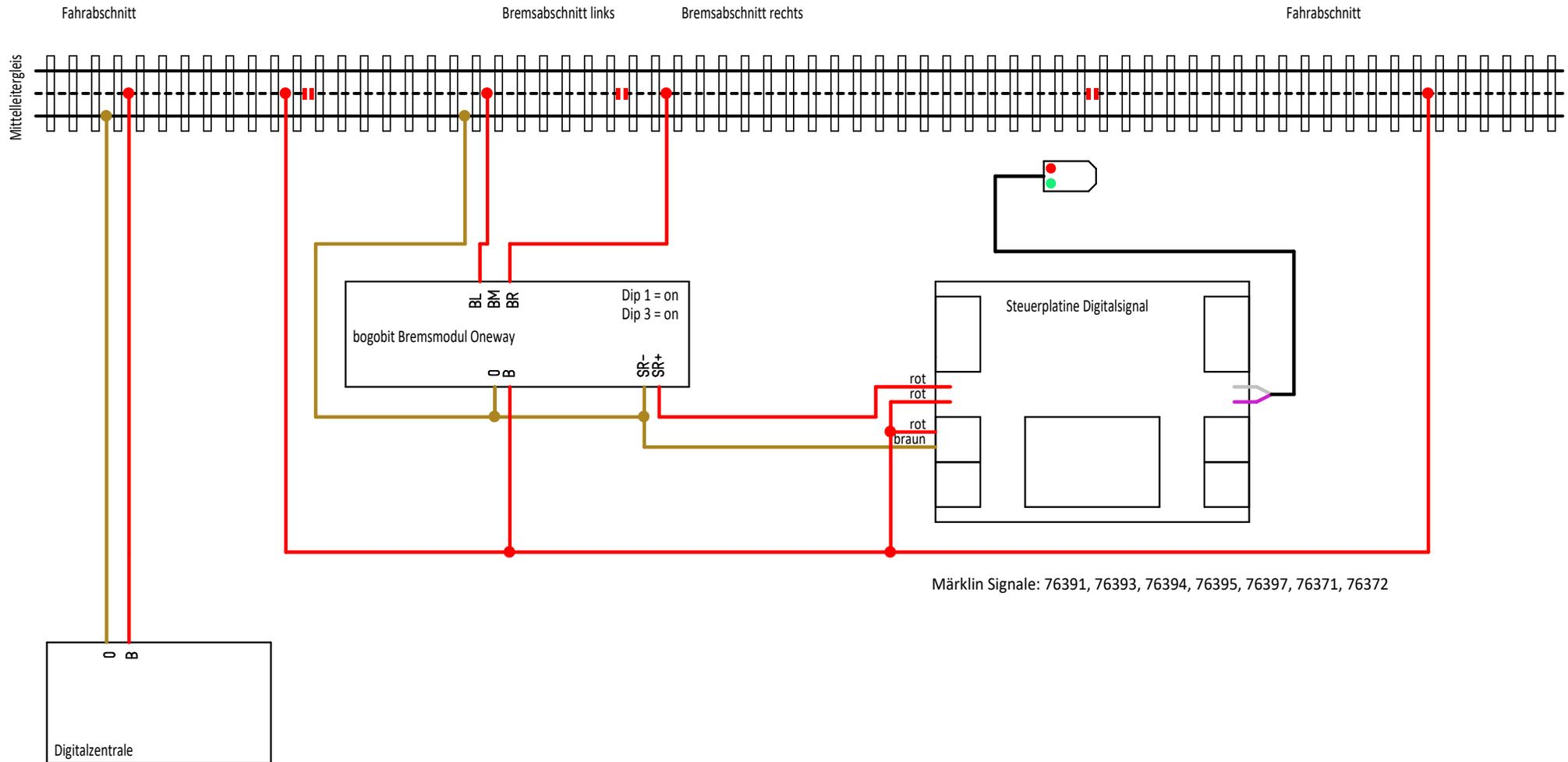
Dieses Prinzip der Ansteuerung ist in beiden Fahrrichtungen anwendbar. Dann Dip 3 = off.
