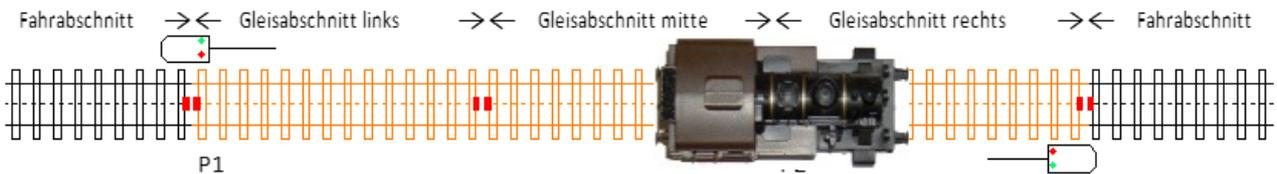
Sobald die Lok in den Gleisabschnitt rechts einfährt (Position P2), gehen alle Gleisabschnitte auf Bremsspannung, die Lok bremst ab.
