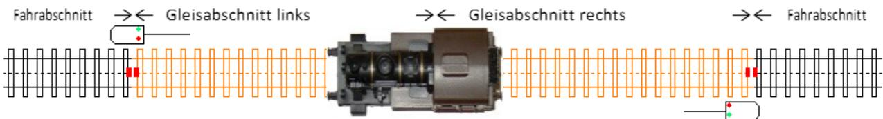
Sobald die Lok in den Gleisabschnitt links einfährt, gehen alle Gleisabschnitte auf Bremsspannung, die Lok bremst ab.
