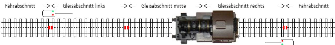
Die Lok fährt von rechts nach links. Auch im Gleisabschnitt rechts und Gleisabschnitt mitte fährt sie noch mit unverminderter Geschwindigkeit weiter.
