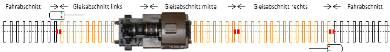
Sobald die Lok in den Gleisabschnitt links einfährt, gehen alle Gleisabschnitte auf Bremsspannung, die Lok bremsst ab.
