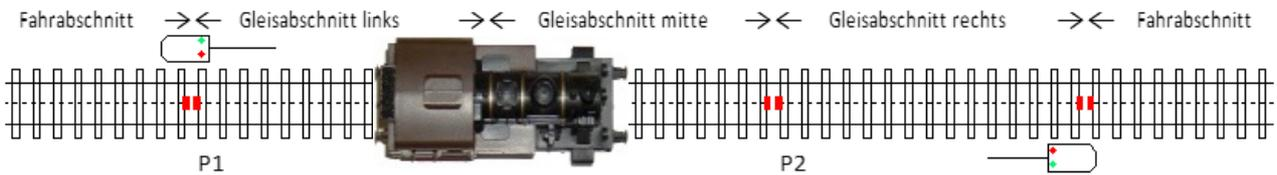
Die Lok fährt von links nach rechts. Auch im Gleisabschnitt links und Gleisabschnitt mitte fährt sie noch mit unverminderter Geschwindigkeit weiter.
