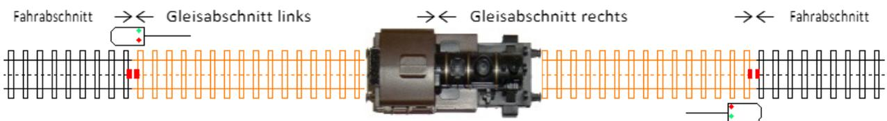
Sobald die Lok in den Gleisabschnitt rechts einfährt, gehen alle Gleisabschnitte auf Bremsspannung, die Lok brems ab.
